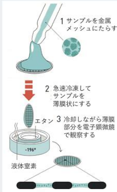
■ 第 1-3-5 図 / サンプルの冷却方法
