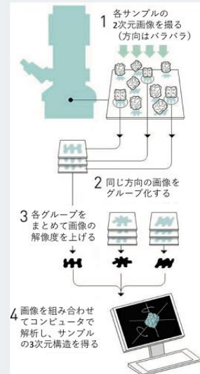
■ 第 1-3-6 図 / サンプルの3次元構造を得る方法
